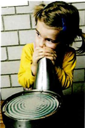
Das Tonoskop ist ein einfacher Apparat, der es ermöglicht, Schwingungsformen ohne elektro-akustische Hilfsmittel sichtbar zu machen. Wir sprechen, singen oder summen in das Tonoskop hinein. Die Membran wird dadurch in Schwingung versetzt und der Sand darauf beginnt, sich in regelmässigen Kreisen anzuordnen. Wir können unsere Stimme nicht nur hören, sondern auch sehen.
